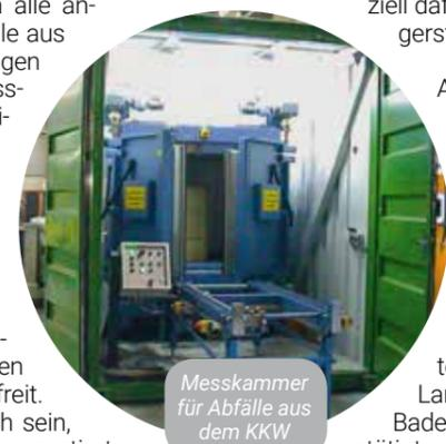
Messkammer für Abfälle aus dem KKW
