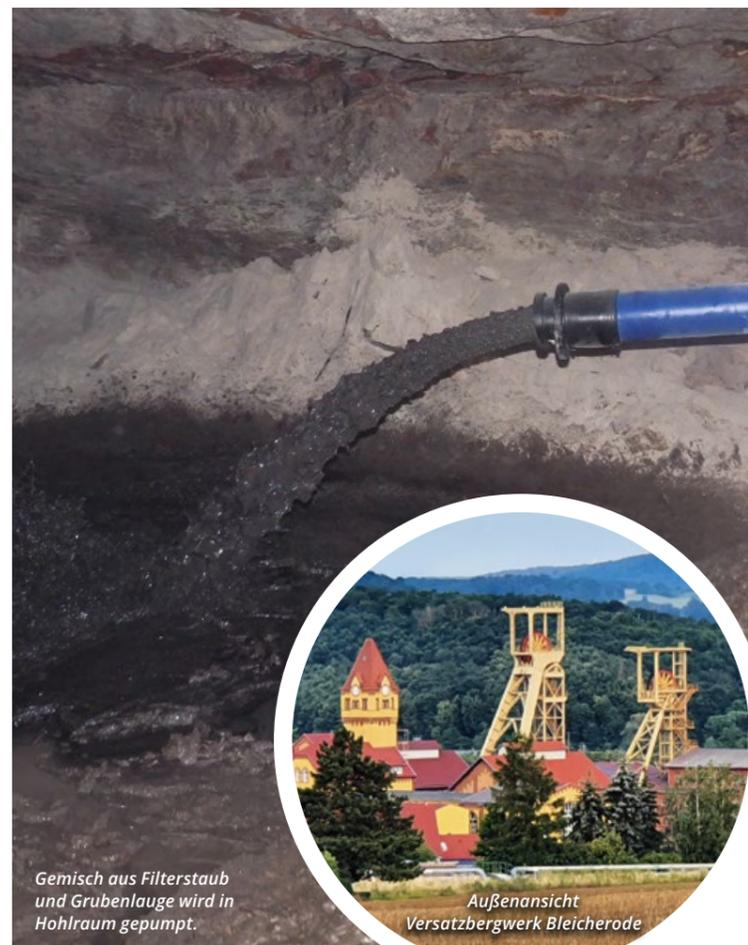
Gemisch aus Filterstaub und Grubenlauge wird in Hohlraum gepumpt.
