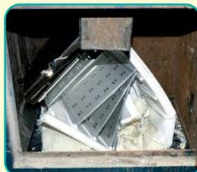
Schreddermaschinen zerkleinern die Einzelteile der Kühlgeräte.
