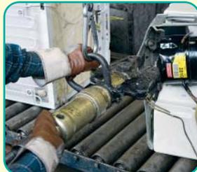
Kompressoren und Kühlkreisläufe werden in sorgfältiger Feinstarbeit entfernt.
