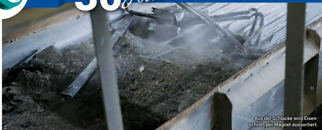
Aus der Schlacke wird Eisenschrott per Magnet aussortiert.
