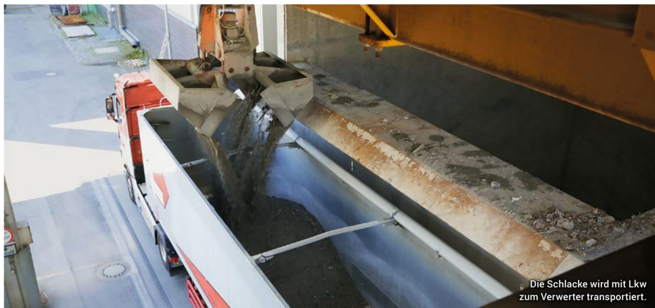
Die Schlacke wird mit Lkw zum Verwerter transportiert.
