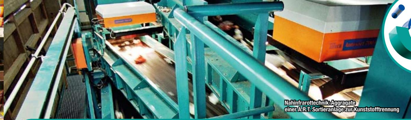
Nahinfrarottechnik-Aggregate einer A.R.T. Sortieranlage zur Kunststofftrennung
