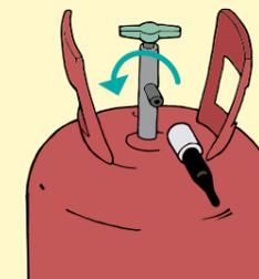
**3.** Entfernen Sie die schwarze Düse. Dazu drehen Sie die weiße Enlüftungsmutter entgegen dem Uhrzeigersinn.
